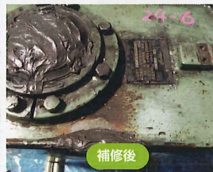
止目材による補修例
